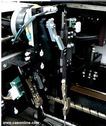
Im Unterschied zum ICT wird beim Flying-Probe-Test nicht mit Nadelbettadapter, sondern mit beweglichen Kontaktfingern gearbeitet.
