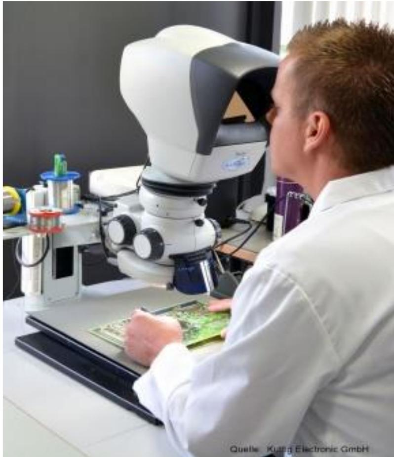
Mit der Sichtprüfung können Fehlerbilder, wie mangelhafte Lötstellen, fehlende Bauteile, mechanische Beschädigungen, verpolte Bauteile und falsche Bauteile erkannt werden.
