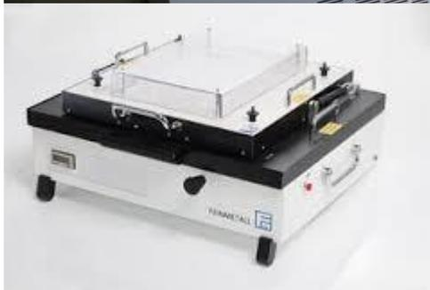
Der ICT ist in der Lage Fehlerbilder wie fehlende Lötstellen, Kurzschlüsse, falsche Bauteile und elektrisch defekte Bauteile nachzuweisen und den Fehler genau zu lokalisieren.
