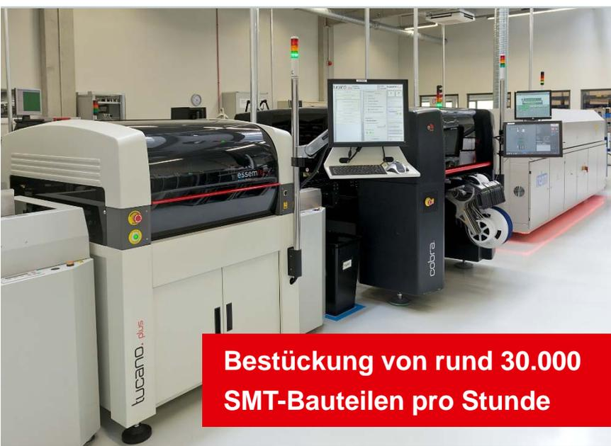
**Bestückung von rund 30.000 SMT-Bauteilen pro Stunde**
