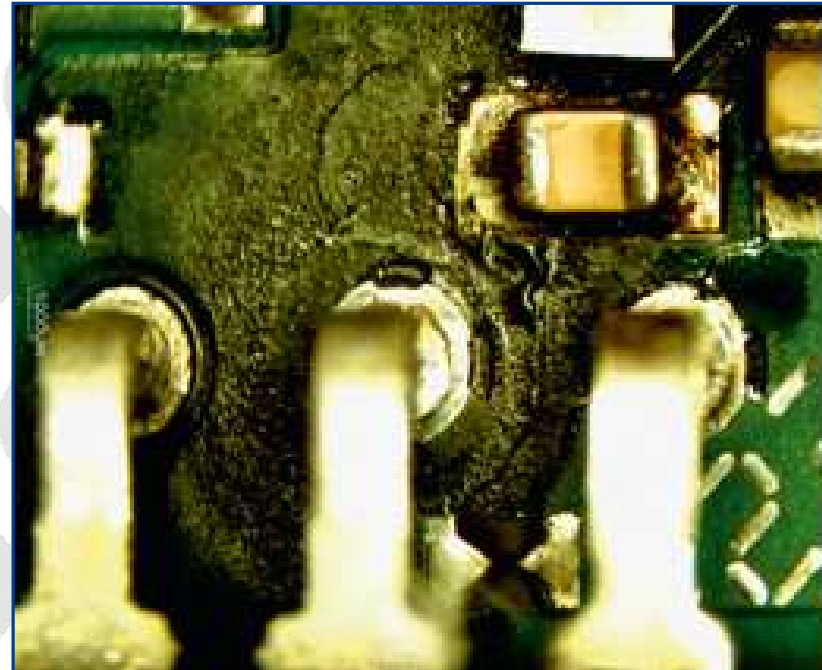
Elektromigration an einer elektronischen Baugruppe (Quelle: AUCOTEAM GmbH)
