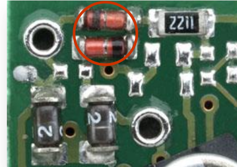
Bestückung: Lage und Polarität der Bauteile
