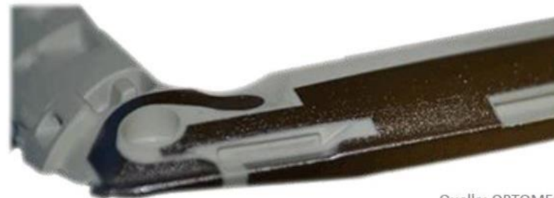
Mit Aerosol Jet Druck integrierte Antenne
