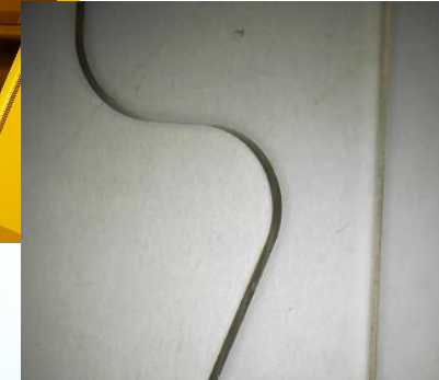
Konturschneiden mit 532nm-Laser
